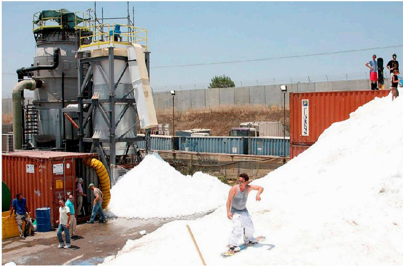
In Israel wird eine Vakuum-Schneekanone getestet – ein vergleichbares Modell wird derzeit in Zermatt installiert.
